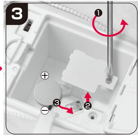
洋服をぬがせて背中のファスナーを開け、①電池カバーロックを回して、電池カバーを開けます。
