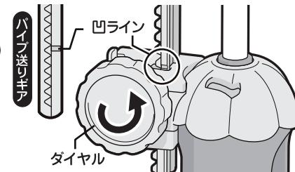
パイプ送りギアの凹ラインが上図の位置にくるまで回してください。
